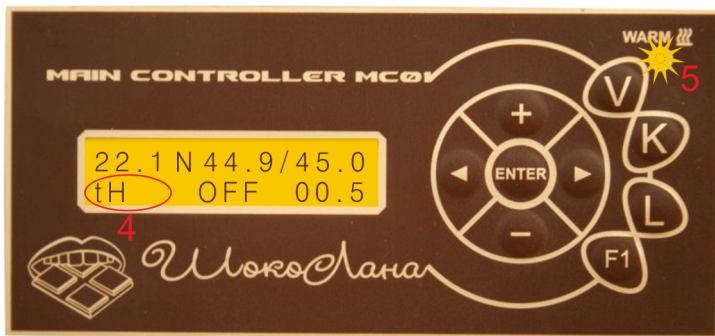
Рис.5. Передняя панель контроллера, включен нагрев, отображается имя уставки.
